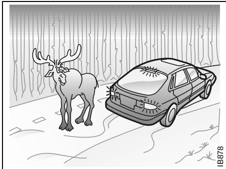
Bromsning med ABS - undanstyrning
