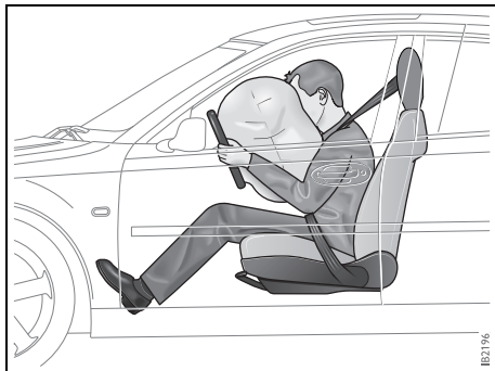
Uppblåst krockkudde (förarsidan). Uppblåsning och tömning av krockkudden tar ca. 0,1 sekunder
